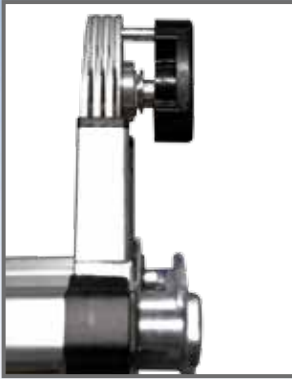
Balama care se trage spre exterior până ce rămâne blocată.
